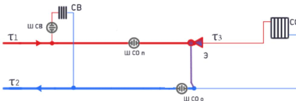
Рисунок 1 – Схема подключения потребителей к двухтрубной тепловой сети (при наличии внутридомовой системы отопления), в качестве регулятора температуры используется элеватор (СО – система отопления, Э – элеватор, СВ – система вентиляции)
