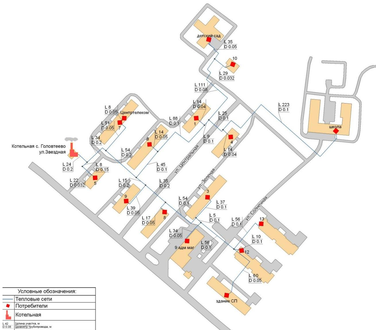
Рисунок 2 – Зона действия источника теплоснабжения котельной с. Головтеево
