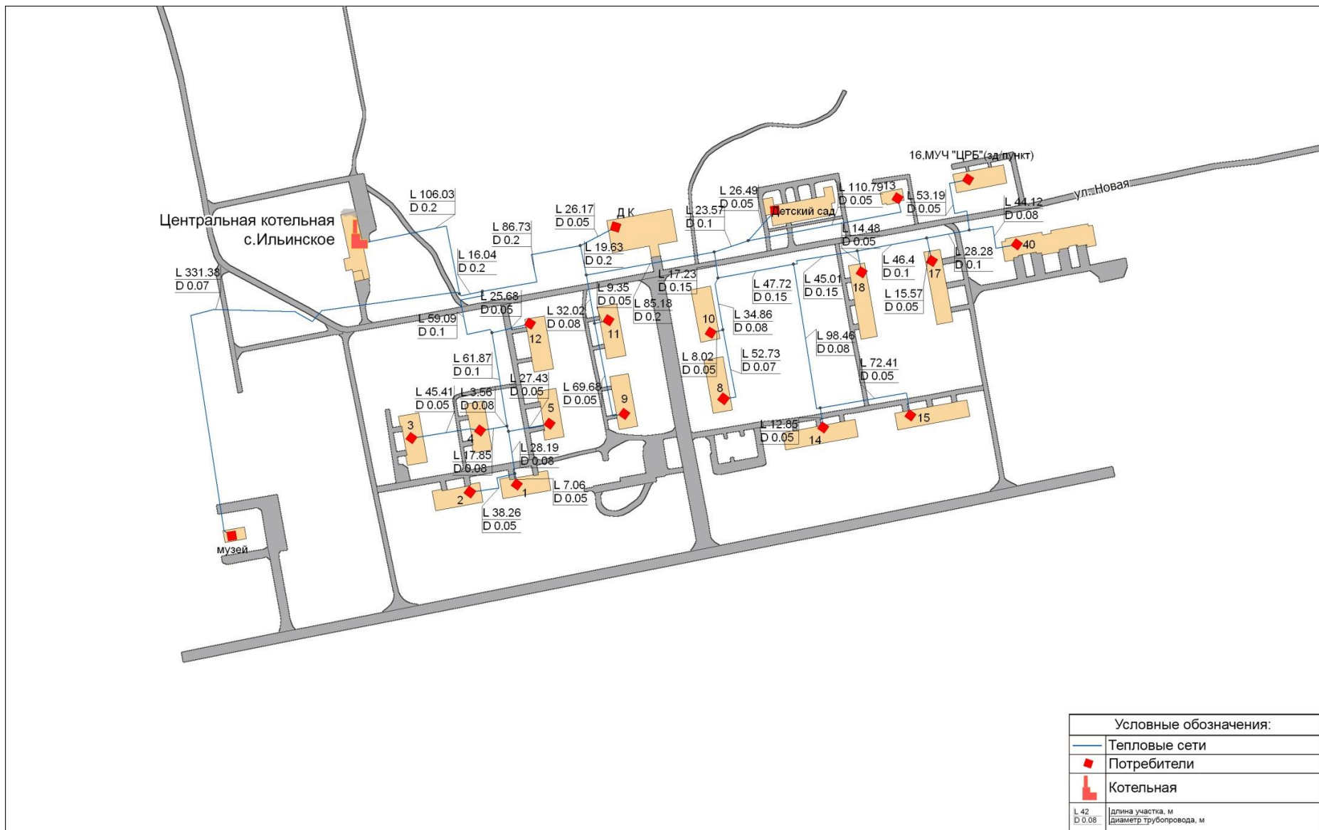
Рисунок 1.3.1 – Схема тепловых сетей котельной Центральная с. Ильинское
