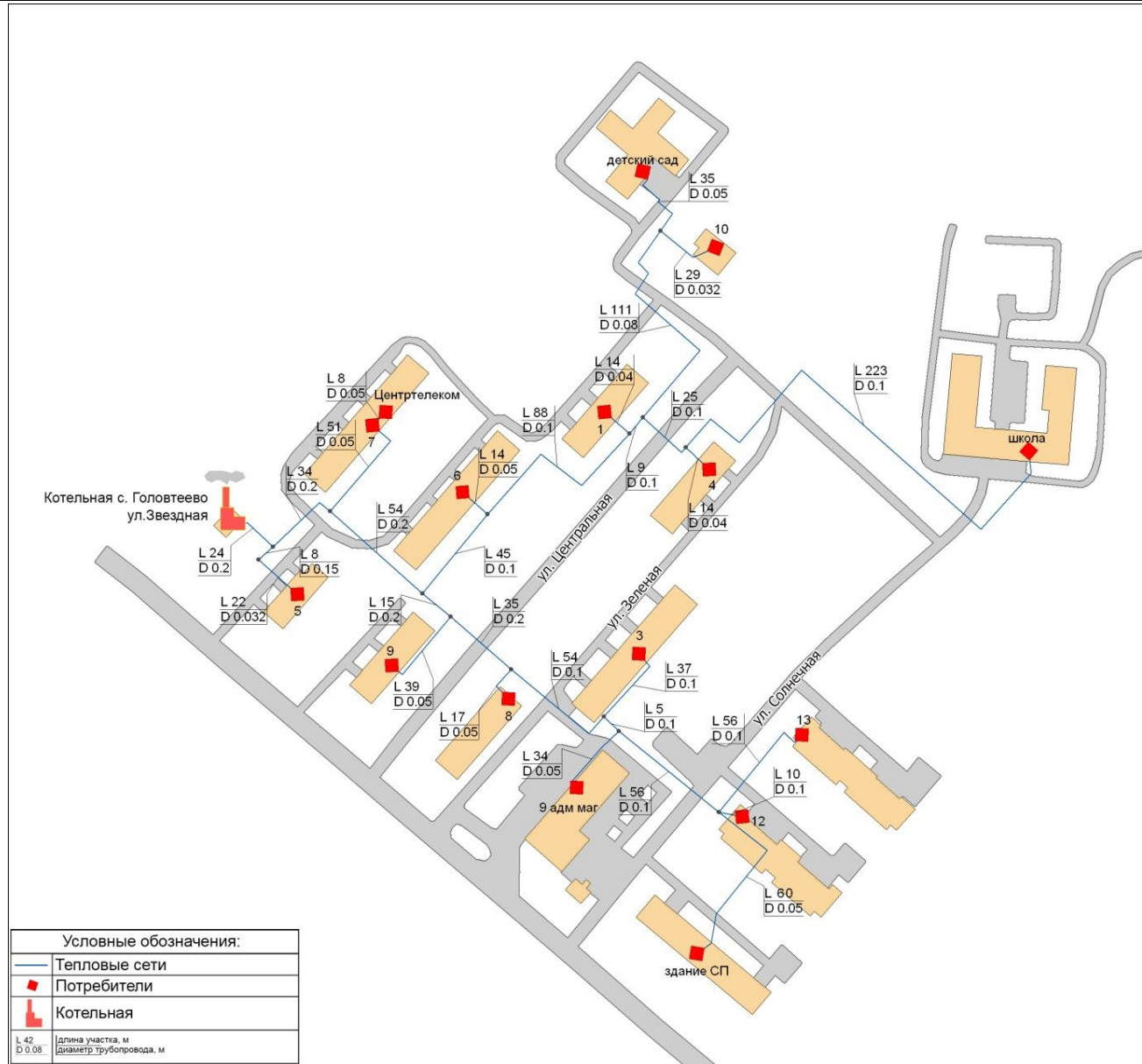
Рисунок 1.3.1 – Схема тепловых сетей котельной
